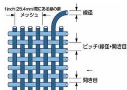
石川金網では線径1.6mmの太いものから、髪の毛より細い0.016mmのマイクロワイヤーまで様々な種類の材料の織り加工を行っています。
