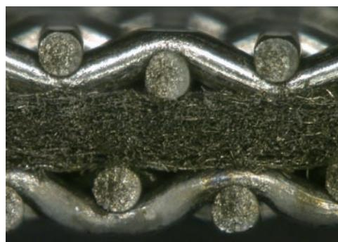
圧延加工を施した線径の太い強度のある織金網を補強メッシュとして使用し、間に保証メッシュ及び金属不織布を入れた多層構造とすることで、高い耐圧性、耐久性が確保され、逆洗(バックフラッシュ)にも耐え繰り返し洗浄が可能となります。焼結加工との違いは、抵抗溶接(スポット溶接)により織金網を張り合わせていることです。
