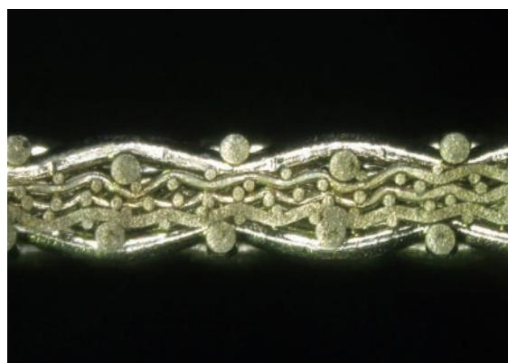
Aタイプの織金網を積層して焼結加工したもの。
